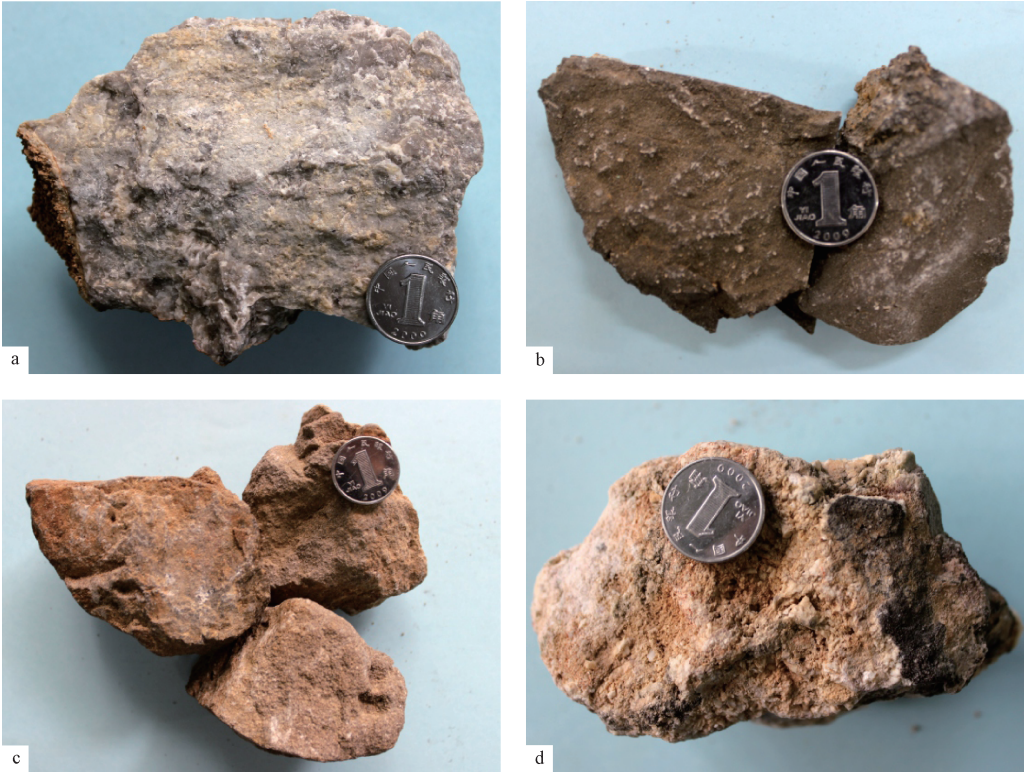
图 3 隆鄂尼地区布曲组白云岩手标本照片 Fig. 3 Photos of dolostone samples from the Buqu Formation of the Longeni area a. 砂屑白云岩;b. 粉-细晶白云岩;c. 细-中晶白云岩;d. 中-粗晶白云岩
